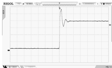
图 4 添加输入延长线（1m）的波形
