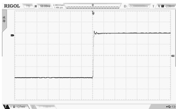
图 3 未添加输入延长线的波形
